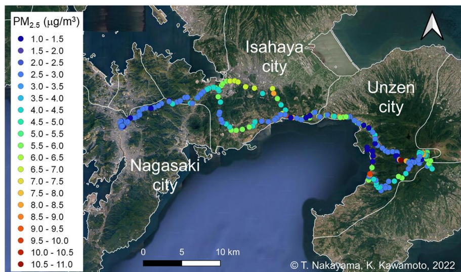
2022年10月22日にモバイル計測器で測定したPM 2.5 質量濃度の例
